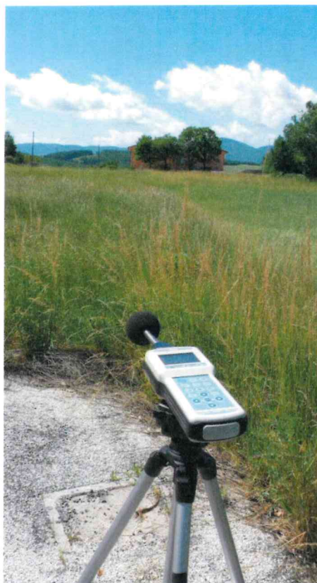
Figura 9 – Posizionamento del fonometro in prossimità del ricettore R2
