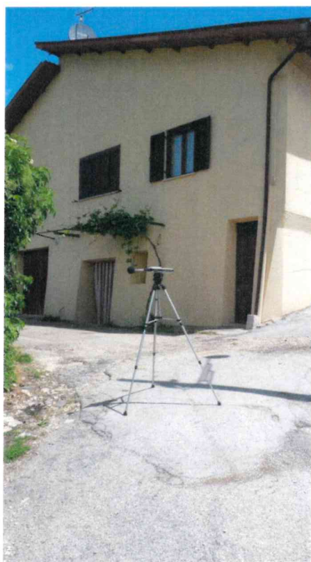
Figura 10 – Posizionamento del fonometro in prossimità del ricettore R3
