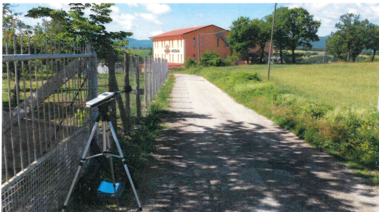
Figura 8 – Posizionamento del fonometro in prossimità del ricevitore R1
