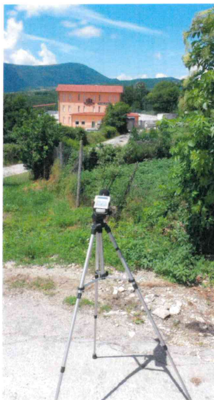
Figura 10 – Posizionamento del fonometro in prossimità del ricettore R3
